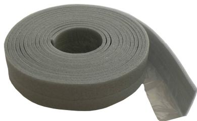
Лента демпферная Энергофлекс Супер предназначена для компенсации температурного расширения бетонно-цементной стяжки в системах отопления типа "теплый пол". Полиэтиленовая пленка служит для предотвращения проникновения жидкого раствора под нижнюю кромку ленты.
