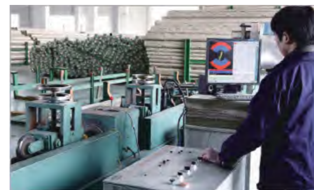
• Испытание вихревыми токами
